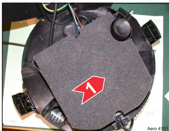
Dämmeinlage (1) montiert auf der Spannplatte.
