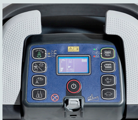
Un tableau de bord à affichage numérique, boutons intuitifs avec icône et commandes ergonomiques
