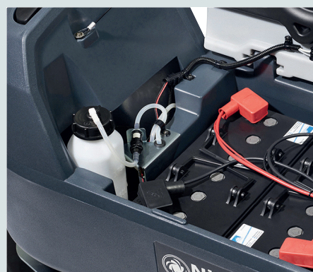
Sistema di dosaggio del detergente per ottimizzarne il consumo
