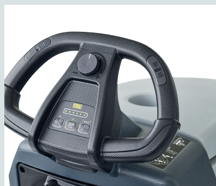
Maniglione ergonomico con pulsante OneTouch™ che attiva tutte le funzioni
