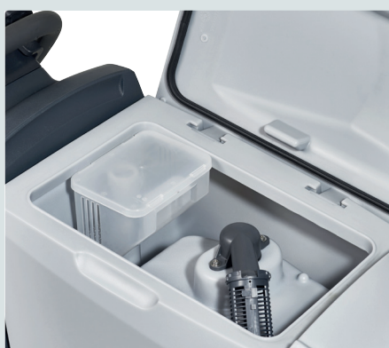
Serbatoio acqua da 45/45 litri e consumo energetico ridotto, in grado di raggiungere le 5 ore di autonomia
