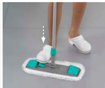
Appuyez avec le pied sur le bouton jaune pour déverrouiller le support
